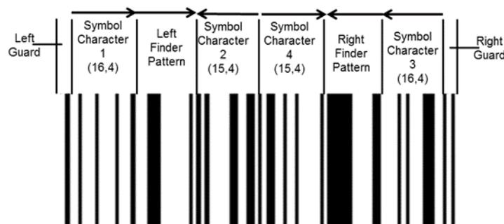
Das linke und rechte Randzeichen des Symbols besteht aus einem schmalen Zwischenraum und einem schmalen Strich. Diese GS1 DataBar Varianten benötigen keine Hellzone.
