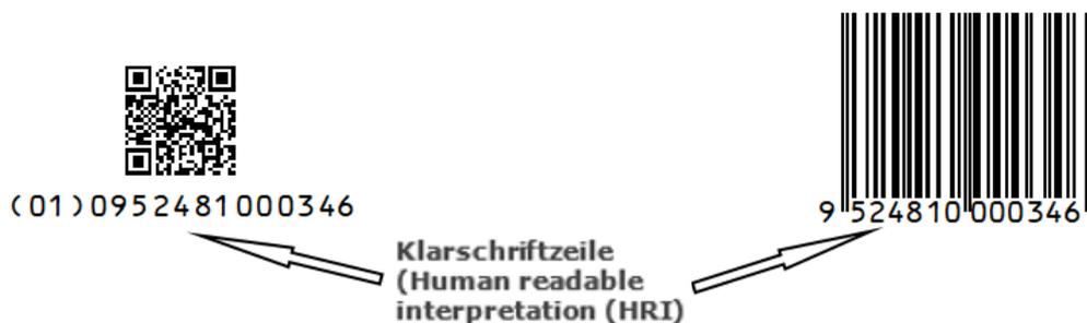
Wenn auf einer Endverbrauchereinheit im Einzelhandel ein UPC-E Strichcode und ein 2D Code nebeneinander platziert werden, MÜSSEN beide Barcodes von einer Klarschriftzeile (HRI) mit einer GTIN begleitet werden, da der UPC-E eine GTIN-12 mit Null-Unterdrückung enthält, wie in Kapitel [5.2.2.4](#) beschrieben.
