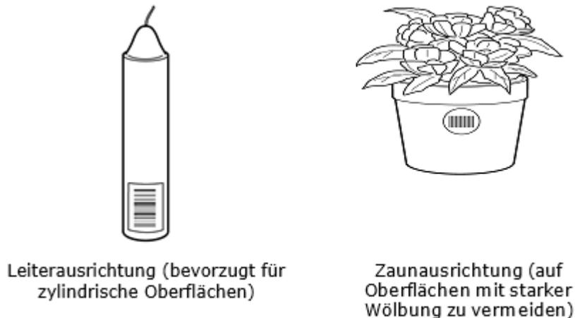
Der Winkel zwischen der Tangente in der Mitte des gewölbten Strichcodes und den Tangenten der Randzeichen (bei der EAN/UPC Symbollogi ist dies die äußere Kante der Randzeichen) MUSS weniger als  $30^\circ$  betragen. Falls dieser Winkel mehr als  $30^\circ$  beträgt, MUSS die Ausrichtung des Strichcodes so gewählt werden, dass die Striche senkrecht zur Umrisslinie der Einheit verlaufen.
