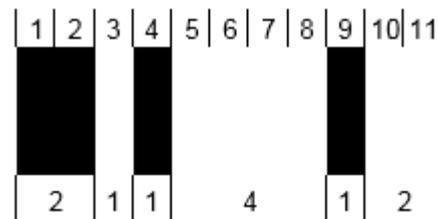
Abbildung 5.4.3.1-2 zeigt die Verschlüsselung des Symbolzeichenwertes 35. Im Zeichensatz A oder B wird damit das Nutzdatenzeichen C, im Zeichensatz C die zwei Nutzdatenzeichen 3 und 5 dargestellt.
