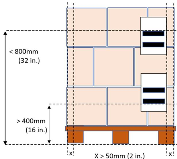
**Abbildung 6.7.1.1-2.** Barcodeplatzierung auf Paletten kleiner als 400 mm (16 inches)
