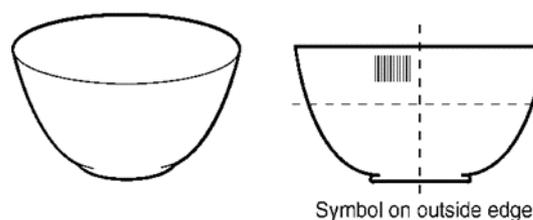
**Abbildung 6.4.16-4.** Barcodeplatzierung auf unverpackten Einheiten
