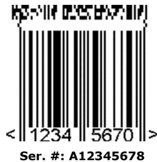
**Abbildung 5.11.8-4.** UPC-E Symbol mit einer 2-spaltigen CC-A Komponente
