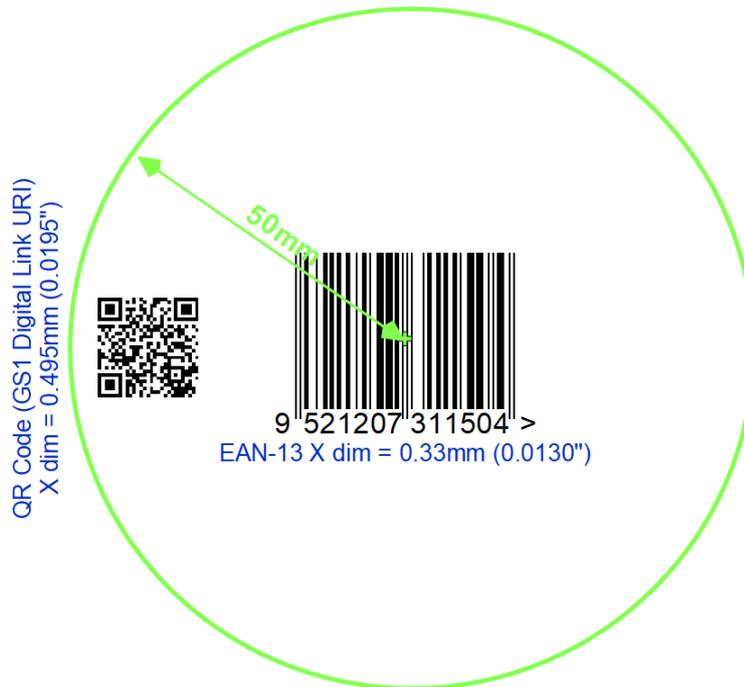
**Abbildung 6.3.3.1-2.** Beispiel für die Platzierung des 2D Codes im Verhältnis zum linearen Strichcode
