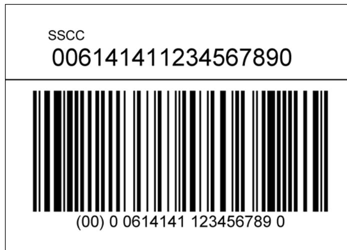
**Hinweise:** Dieses Beispiel zeigt ein Etikett, das ausschließlich einen SSCC enthält. Diese Etiketten können in der Produktion aufgebracht werden, aber auch während des Transports oder beim Empfang, falls noch kein Etikett auf der Transporteinheit vorhanden ist.
