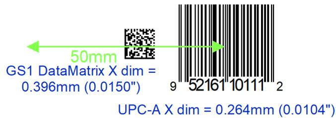
**Abbildung 6.3.3.1-3.** Beispiel für die Platzierung des 2D Codes im Verhältnis zum linearen Strichcode auf einem Hängeetikett
