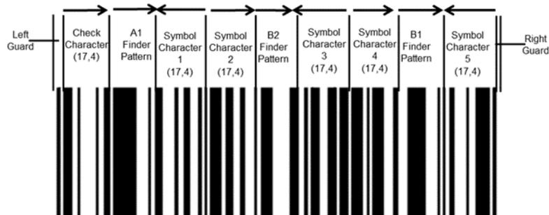
Das linke und rechte Randzeichen des Symbols besteht aus einem schmalen Zwischenraum und einem schmalen Balken. GS1 DataBar Expanded Varianten benötigen keine Hellzone.
