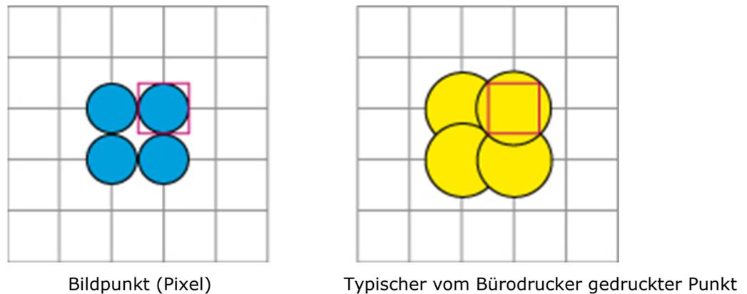
Die übliche Druckdichte von Bürodruckern für den Strichcodedruck liegt bei 200 und 300 dpi. Diese Drucker können jedoch aufgrund von Beschränkungen in Bezug auf den Punktabstand nicht genau die minimale X-Modulbreite von 0,264 mm (0,0104 inch) oder 80% Vergrößerungsfaktor drucken. Der nächste Wert zu 80%, den diese Drucker erreichen können, ist 75,7% oder 76,9%, abhängig von der exakten Punktgeometrie (siehe nachfolgende Abbildung).
