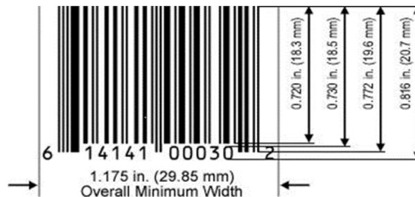
✓ **Anmerkung:** Bei kleiner werdender Vergrößerung von 80% auf 75% steigt die Breite der Hellzonen von 2,38 mm (0.094 inch) auf 3,16 mm (0.124 inch), um die Gesamtbreite auf 29,85 mm (1.175 inch) konstant zu halten.
