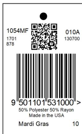
**Abbildung 6.3.3.1-4.** Beispiel für die Platzierung des 2D Codes im Verhältnis zum linearen Strichcode mit maximaler X-Modulbreite für POS
