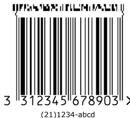
**Abbildung 5.11.8-2.** UPC-A Symbol mit einer 4-spaltigen CC-B Komponente
