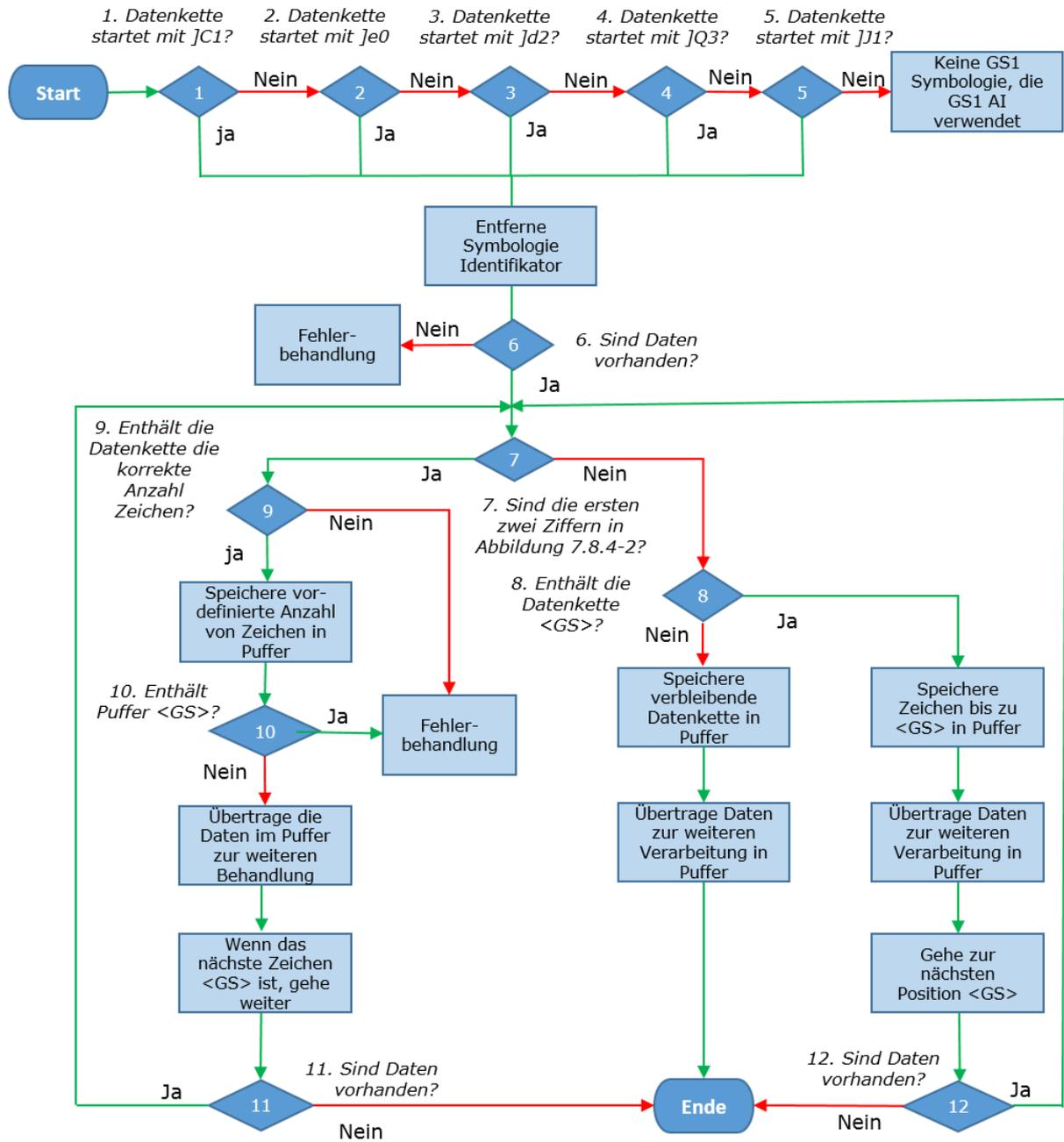
Diese Systemlogik gilt für alle GS1 Symbologien, welche den GS1 Application Identifier Standard verwenden. Nachstehend die Bedeutung der in Abbildung 7.8-1 gelisteten Symbologie-Identifikatoren:
