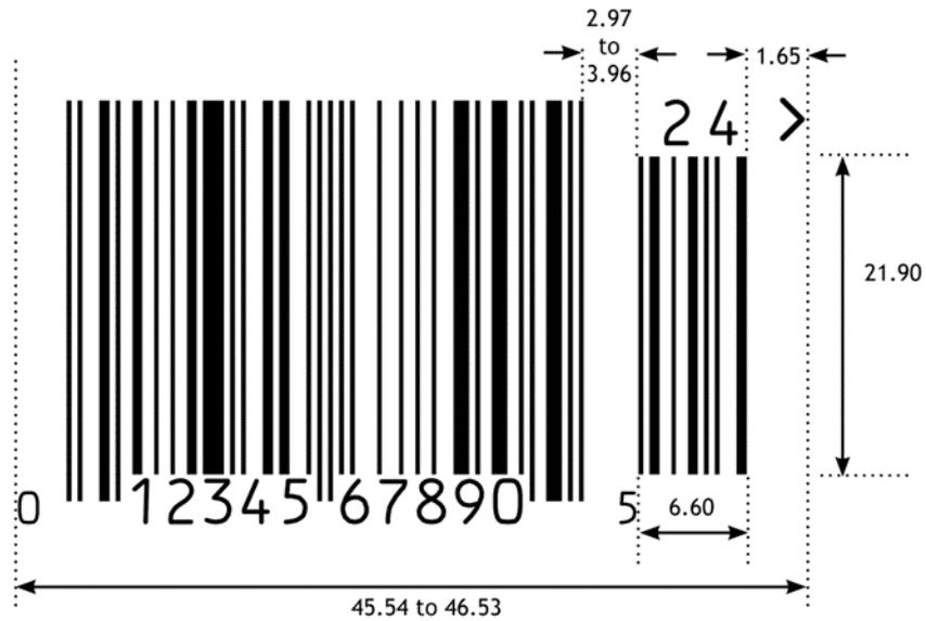
**Abbildung 5.2.6.6-6.** EAN-13 Strichcode mit fünfstelligem Zusatzsymbol
