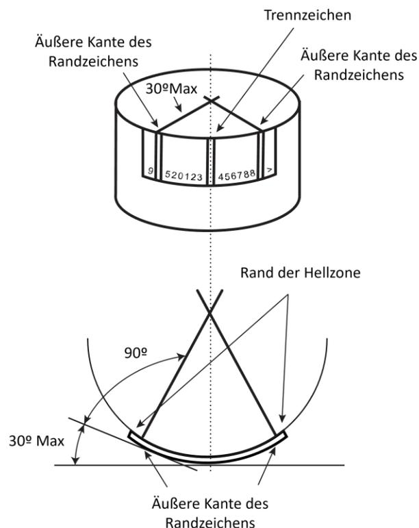
Die folgenden Abbildungen [6.2.3.2-3](#) und [6.2.3.2-4](#) zeigen den Zusammenhang zwischen den zulässigen Dimensionen des X-Moduls (Breite des kleinsten Elementes) für Einheiten unterschiedlicher Durchmesser und die minimalen Durchmesser für verschiedene X-Dimensionen für Strichcodes, die in Zaunorientierung gedruckt werden. Siehe Kapitel [5.12](#) für die minimale, empfohlene und maximale X-Dimension eines Strichcodes, abhängig von der Scanningumgebung.
