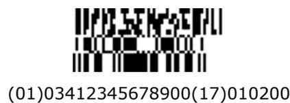
**Abbildung 5.11.8-7.** GS1 DataBar Limited Symbol mit einer 3-spaltigen CC-B Komponente
