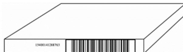
Manchmal werden zwei Strichcodes auf variablen Einheiten angebracht. Ist es notwendig, die Klarschriftzeile unterhalb des Strichcodes zu entfernen, MÜSSEN die Zeichen links neben den Strichen des Hauptbarcodes angebracht werden. Die Klarschriftzeile des zusätzlichen Barcodes wird rechts neben den Strichen des Zusatzsymbols angebracht.
