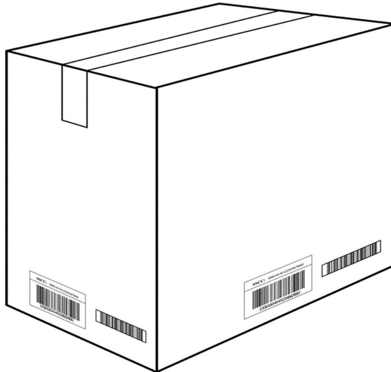
Wenn die Möglichkeit besteht, beide Teile des Dateninhalts in einem GS1-128 Strichcode abzubilden, MÜSSEN diese verkettet zu einem Strichcode zusammengefügt werden. Zusätzliche Strichcodes, die für die vollständige Produktidentifikation essenzielle Informationen enthalten (z. B. Maßangaben), MÜSSEN immer in der Nähe und rechts von dem Hauptbarcode angebracht werden.
