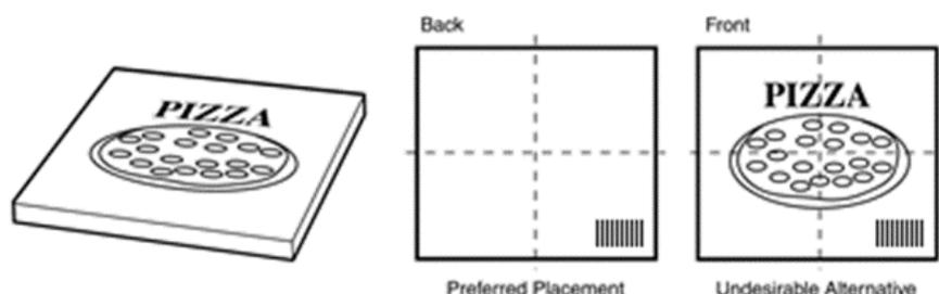
**Abbildung 6.4.12-2.** Unverpackte Einheiten ohne Platz für Barcodeplatzierung auf der Unterseite
